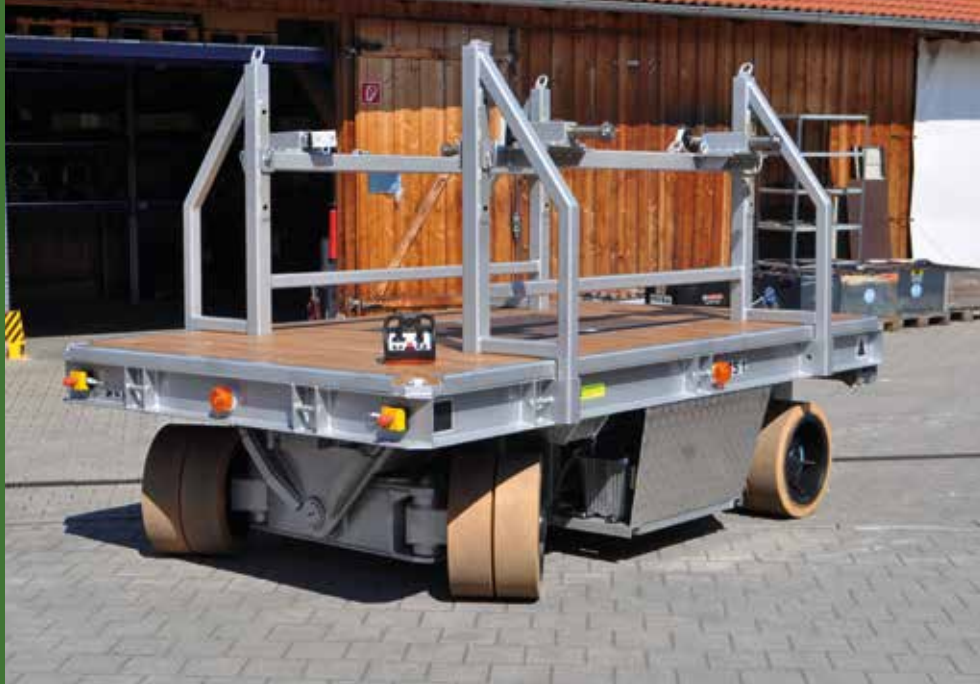
Model 40868600 EGW: 35 t, press die transport
