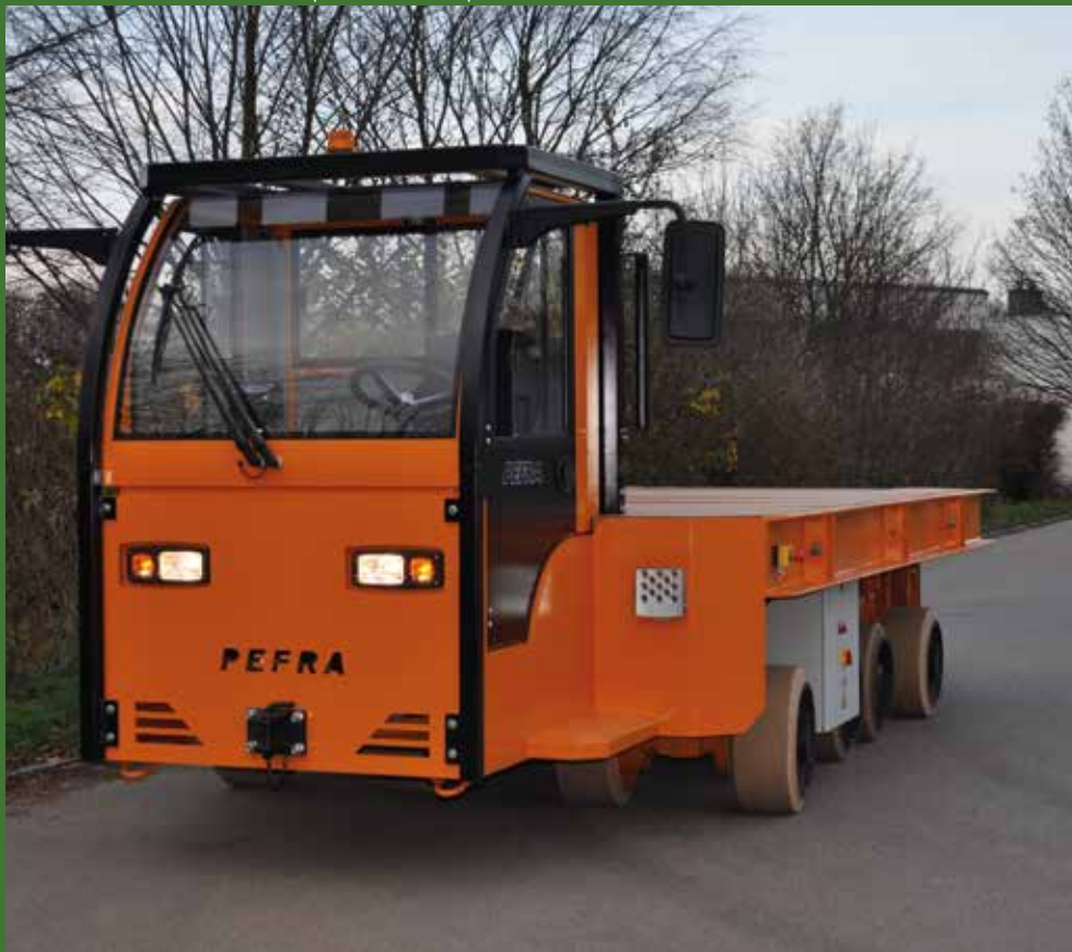
Model 40868600 EGW: 35 t, press die transport
